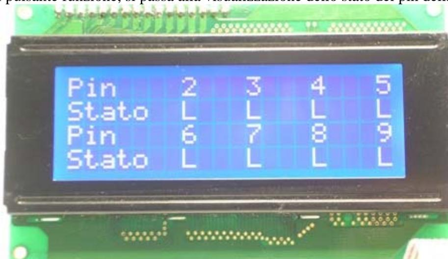
In particolare nella foto si visualizza lo stato dei pin normalmente riservati al pilotaggio tramite segnali STEP e DIR dei motori.
